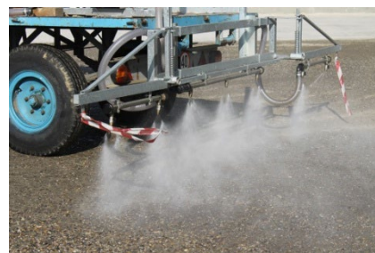
Esempio di un mezzo utilizzato per la bagnatura dei piazzali e delle piste
