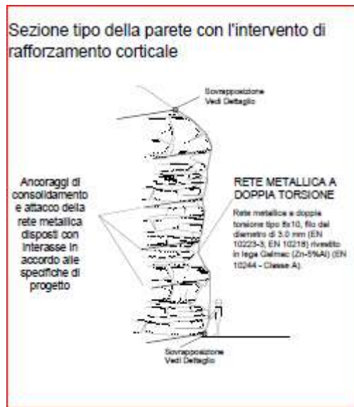
Particolari reti in aderenza in fili acciaio a doppia torsione
