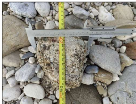
Figura 4.11 Esempio di misura di un sedimento in alveo.
