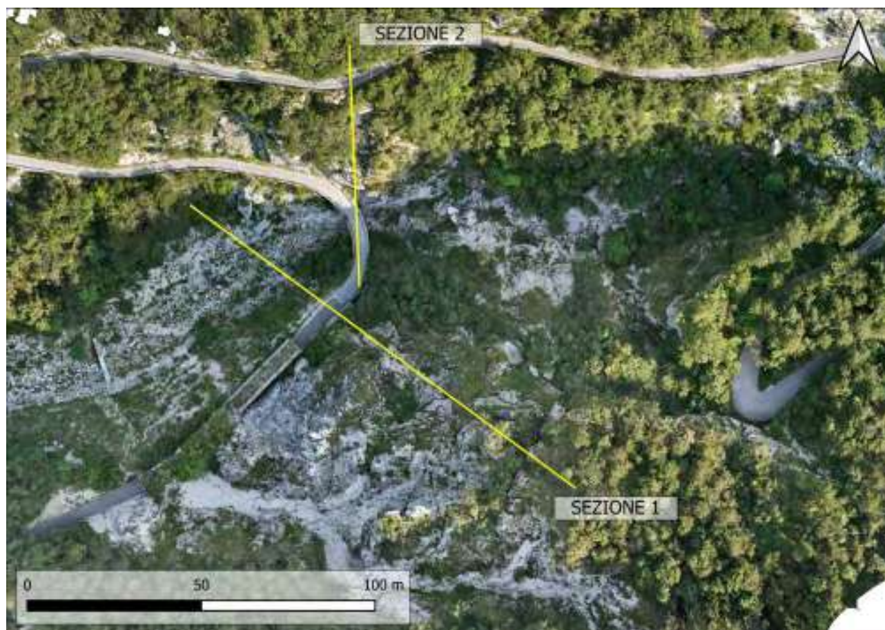
Figura 39. Rappresentazione topografica dell'area di studio in scala 1:1 500, con indicazione delle sezioni per l'analisi 2D della caduta massi nel sito di intervento (ortofoto derivante da rilievo drone).
