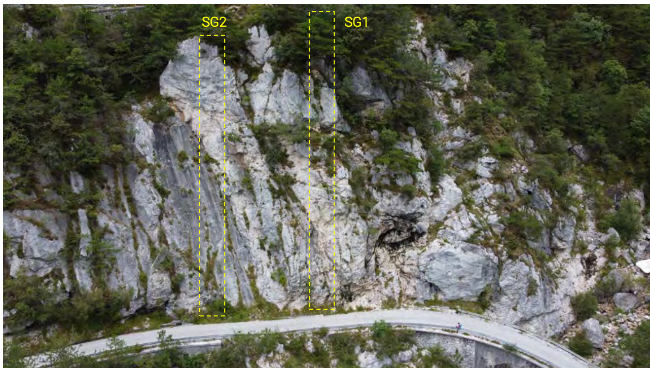
Figura 25. Panoramica dell'affioramento roccioso nell'area di intervento, con indicazione delle linee di scansione.
