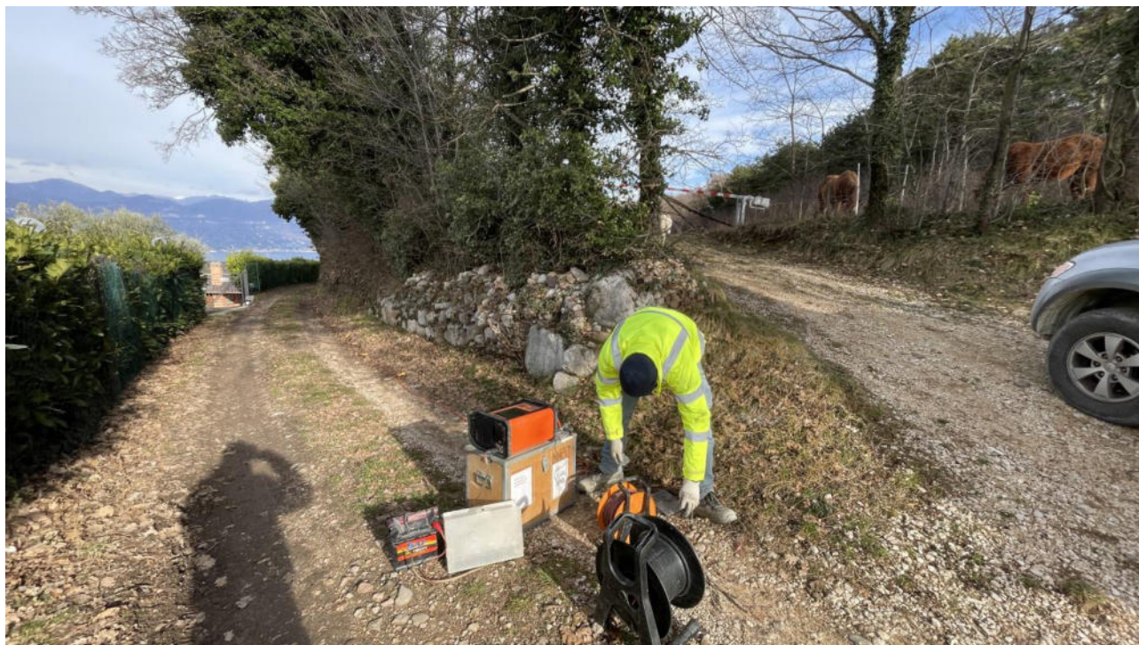
Fig. 2: Esecuzione prova MASW-REMI
