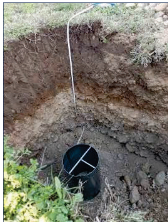
Sezione stratigrafica da trincea esplorativa senza intercalazioni sabbiose e ghiaie da - 0,90 da p.c.
