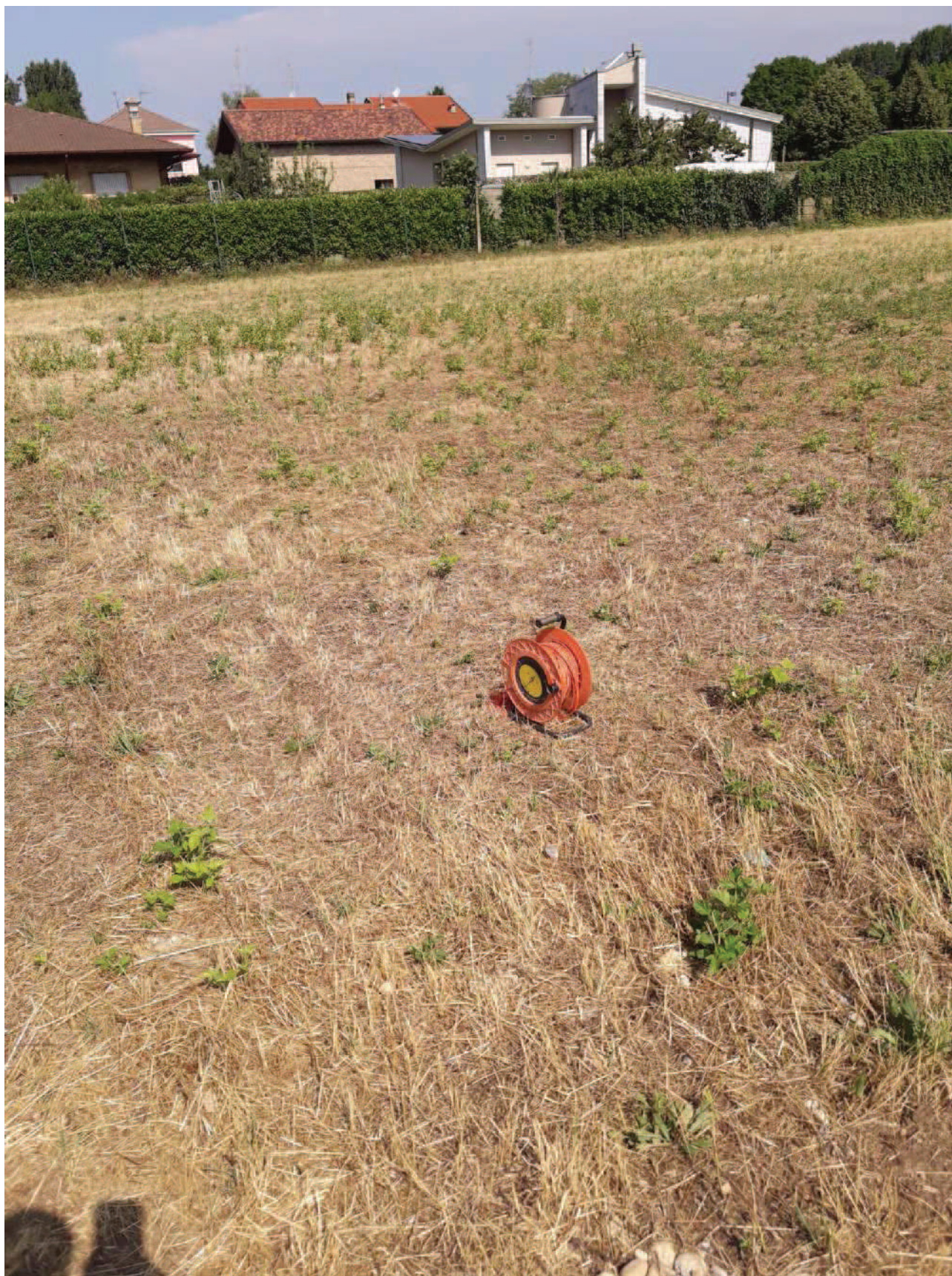
MISURA PIEZOMETRICA CON FREATIMETRO ACUSTICO-ELETTRICO
