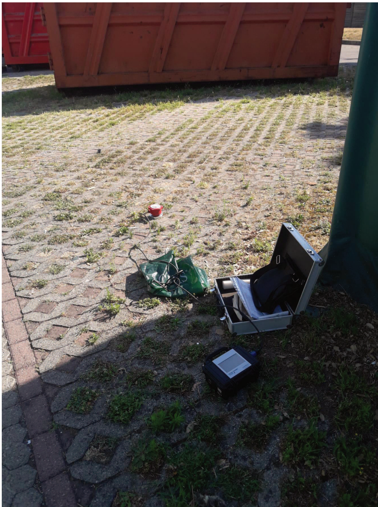
PROVA GEOFISICA “HVSr-3” ESEGUITA NEL CORTILE ESTERNO IL CAPANNONE ESISTENTE
