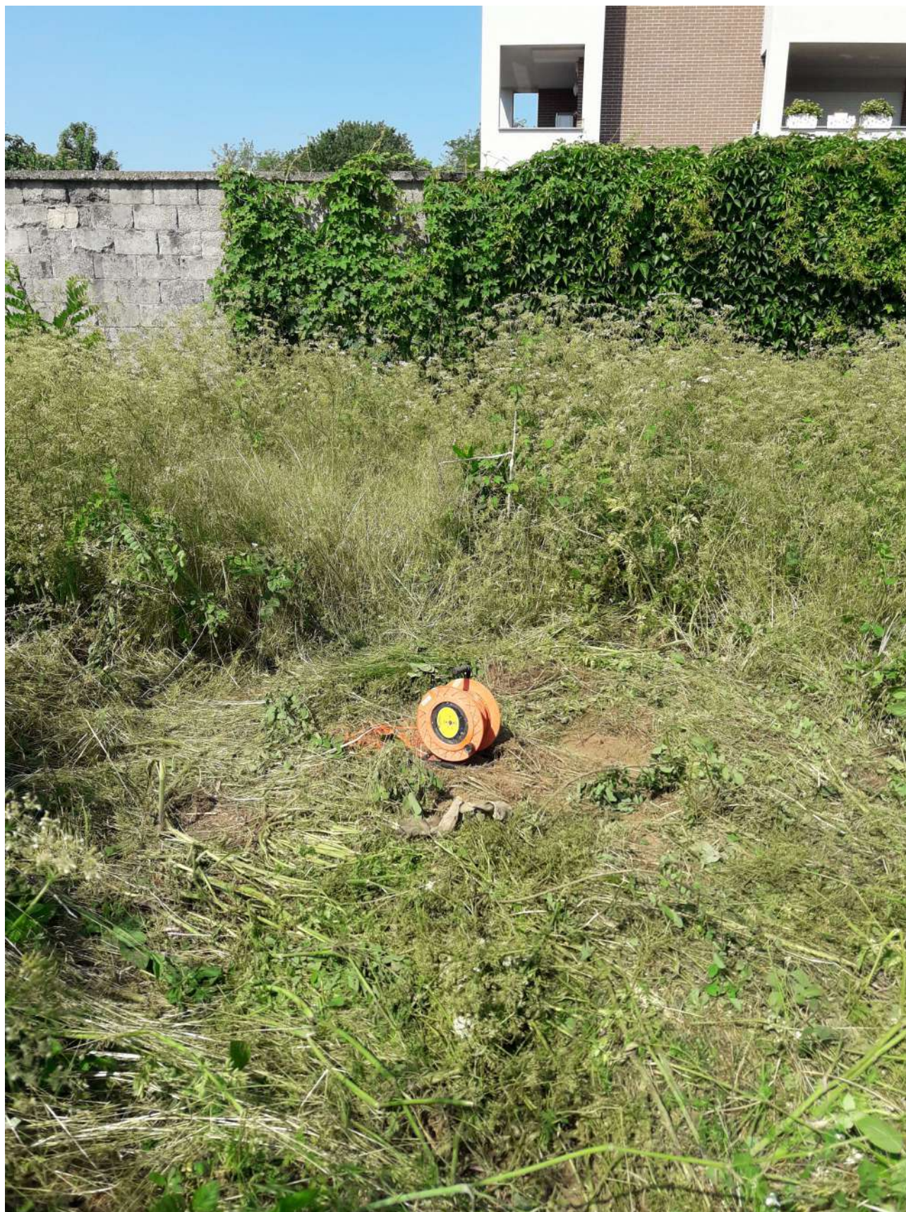
VERIFICA DEL LIVELLO DI FALDA CON FREATIMETRO ACUSTICO-ELETTRICO- NO LIQUEFAZIONE DEI TERRENI
