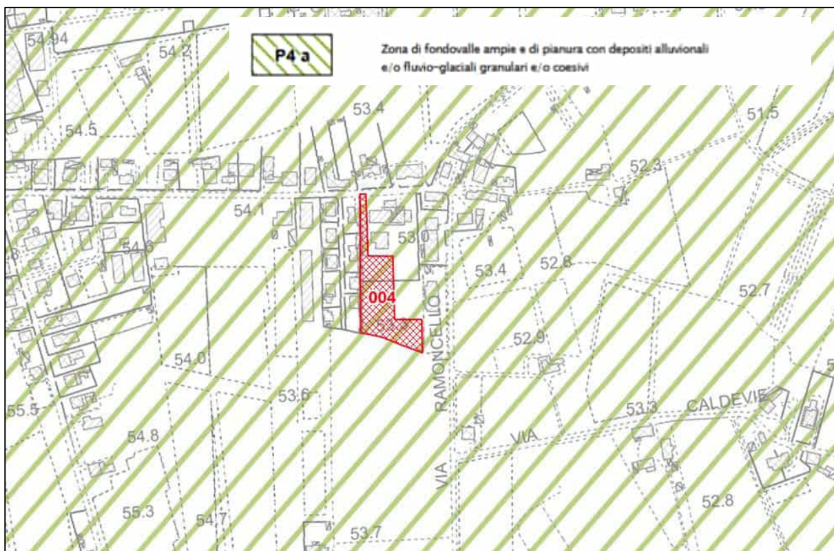
Figura 16. Estratto da Carta della pericolosità sismica locale dello studio di Microzonazione Sismica di Livello 3 del Comune di Santa Lucia di Piave. Il poligono rosso indica l'area in studio.
