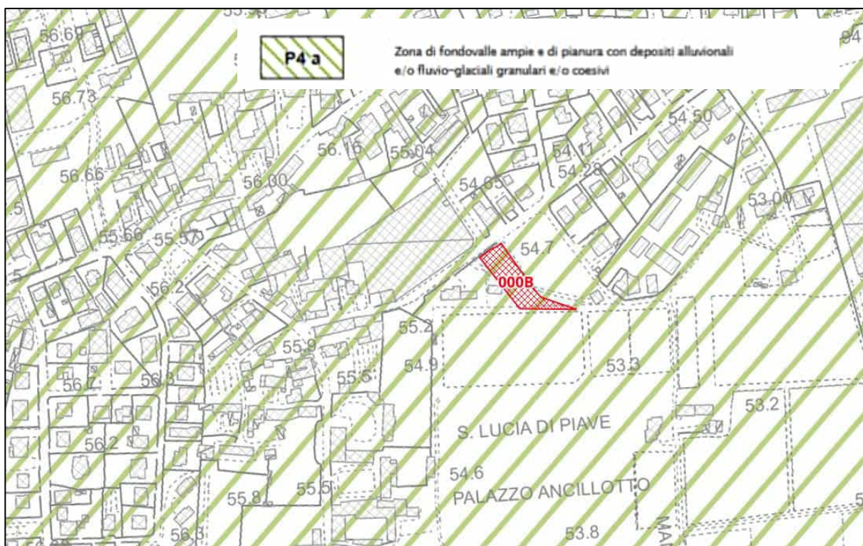
Figura 4. Estratto da Carta della pericolosità sismica locale dello studio di Microzonazione Sismica di Livello 3 del Comune di Santa Lucia di Piave. Il poligono rosso indica l'area in studio.
