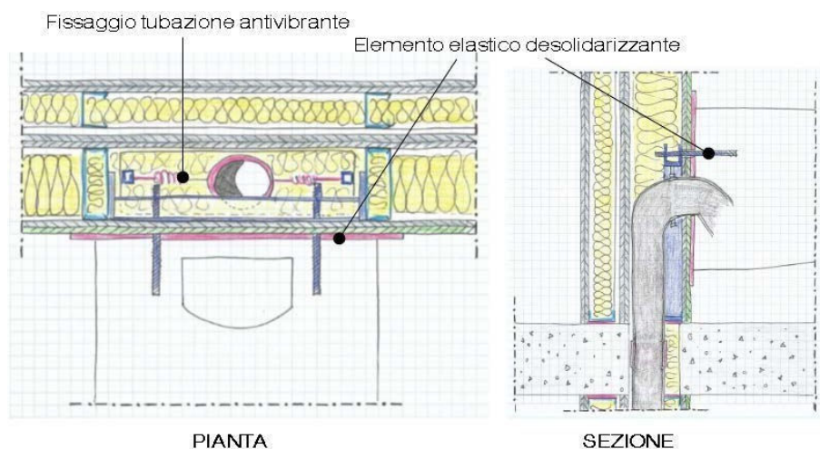
Esempi Fissaggio sanitario sospeso su struttura a secco: pianta e sezione
