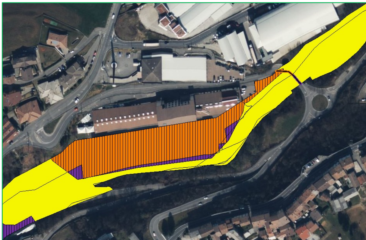
Figura 26 - Aree R4 lungo il Torrente Romna nella zona dell’insediamento “Nuova Gandiplast”
