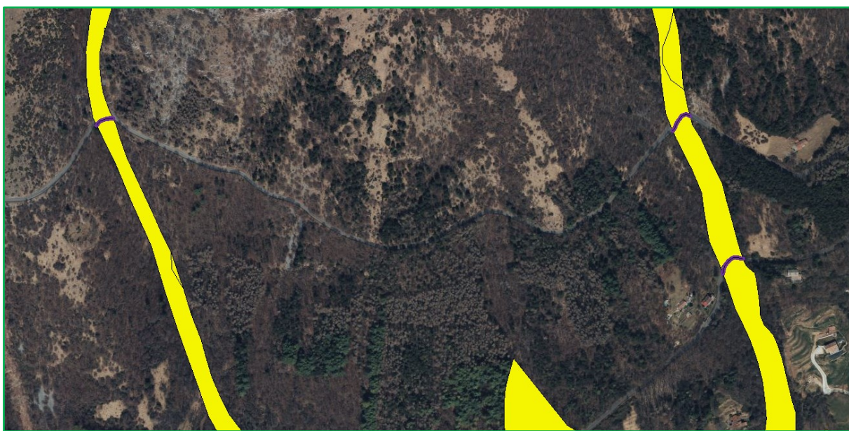
Figura 5 - Aree R4 in corrispondenza dei tombotti della Valle di Pino e della Valle del Tuono in intersezione sulla strada del Farno
