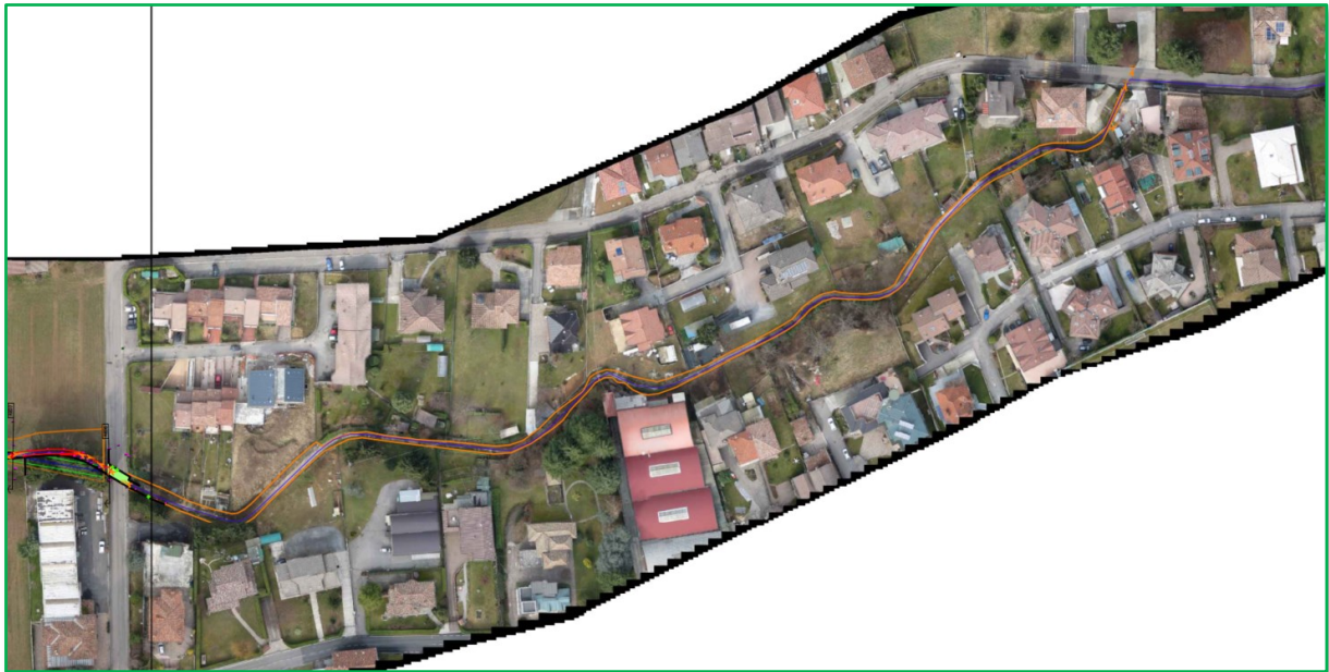
Figura 31 – Assenza di aree allagabili lungo il Torrente Re nella zona del tombotto tra Via Fantoni e Via Canevali
