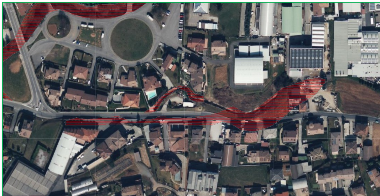
Figura 33 - Aree P.A.I. "Ee" lungo il Torrente Togna in Via Innocenzo XI a confine con Cazzano Sant'Andrea; si nota l'evidente discrepanza tra l'alveo del torrente (freccie gialle) e l'area "Ee" che, stranamente, si discosta dall'alveo invadendo la soprastante Via Innocenzo XI (ma solo parzialmente) con una geometria senza alcun senso né topografico né idraulico, per poi terminare nel nulla
