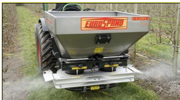
Figura 24 - Esempio di spandiconcime localizzato mono/bilaterale per frutteti (Foto: EuroSpand)
