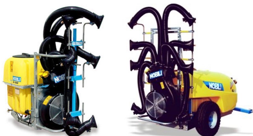
Figura 25 - Esempi di atomizzatore portato a spalla e trainato con getti orientabili per trattamenti su colture arboree (Foto: Nobili S.r.l.)
