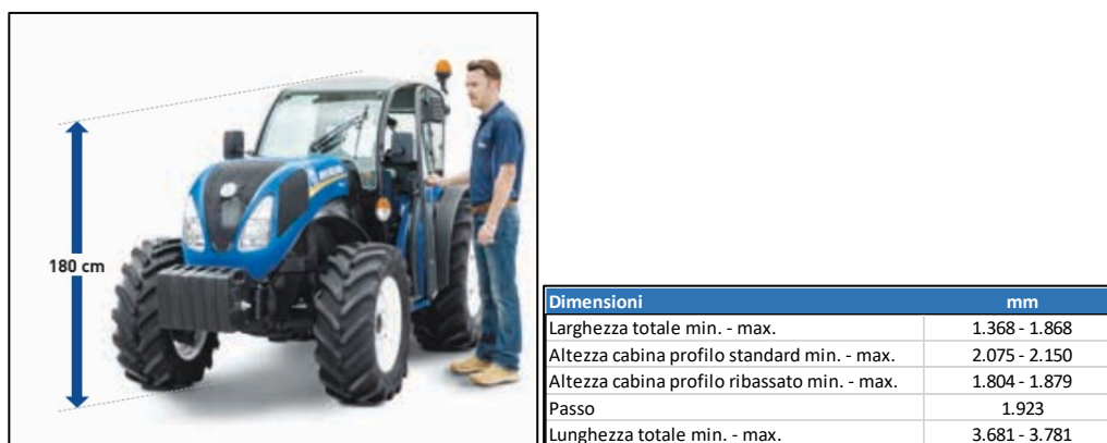
Figura 22 - Dimensioni caratteristiche di un trattore da frutteto con cabina ribassata (Fonte: CNH)
