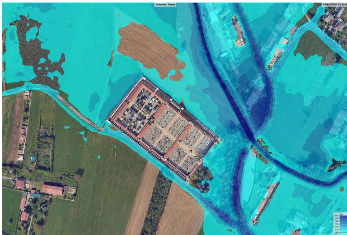
Fig.16: Dettaglio tiranti idrici in corrispondenza della zona di prevista espansione cimiteriale (livelli maggiori di 40 cm esclusivamente in corrispondenza della depressione prossima al muro nord ovest, ove si genera ristagno
