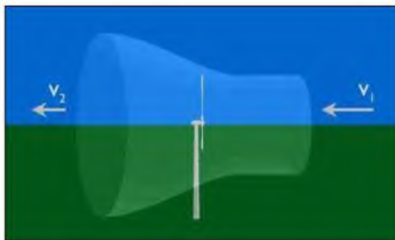
Effetto scia per un aerogeneratore
