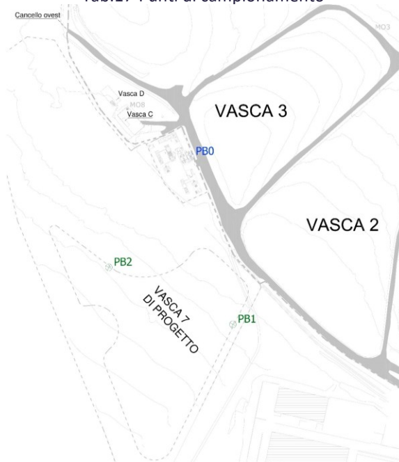
Fig. n. 7 - Stralcio planimetrico dei punti di monitoraggio del biogas
