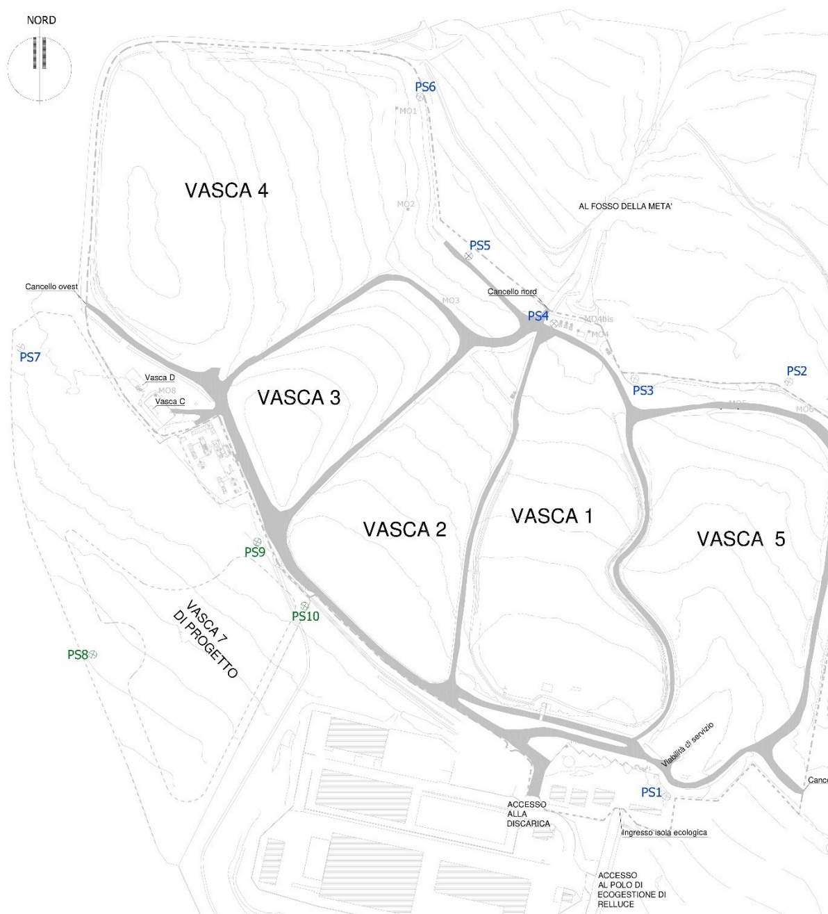
Fig. n. 8 - Stralcio planimetrico punti di monitoraggio acque sotterranee (piezometri)
