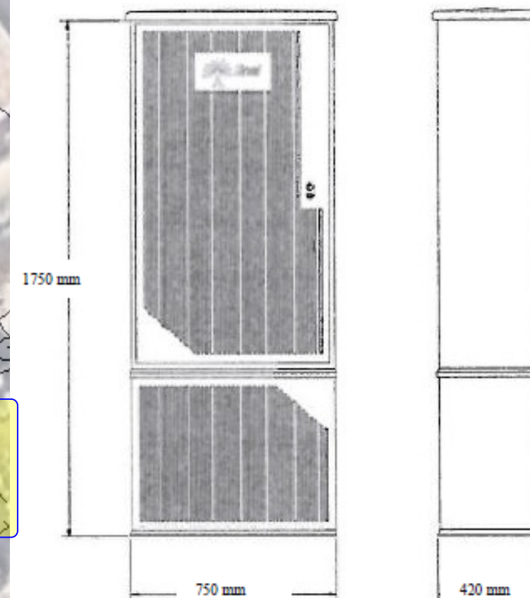
PARTICOLARE 1 Contenitore Per Forniture > 30kw
