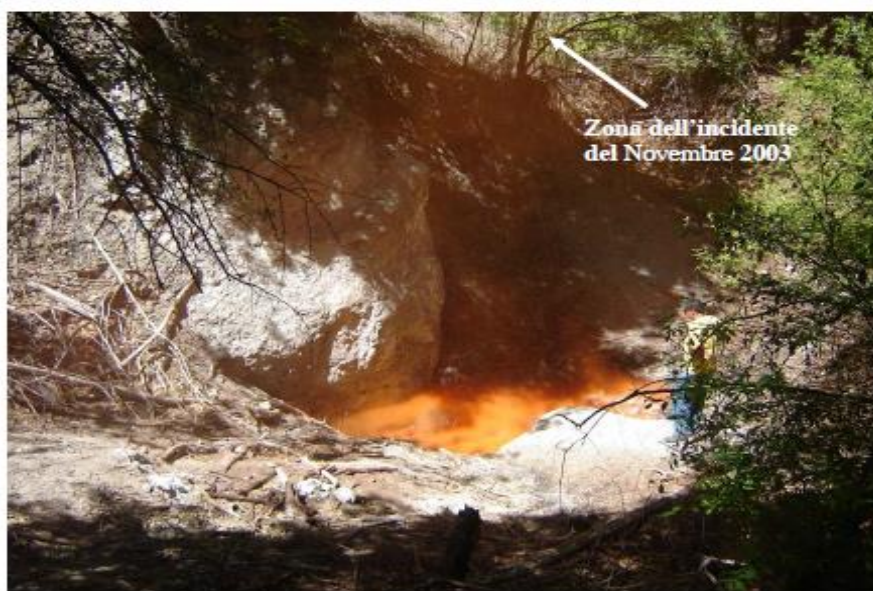
Esperimenti con fumogeni alla Buca delle Colline. La nuvola del fumogeno simula quella della CO 2 e permane dentro la zona di emissione
