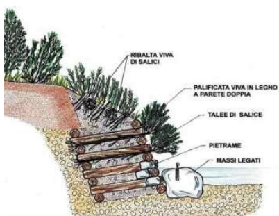
Esempio 24 -Schema consolidamento spondale con palificata viva
