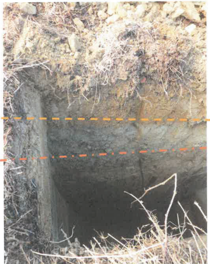
Trincea esplorativa TR3. Si nota la buona coesione del deposito limo-sabbioso e lo spessore dei materiali di riporto.
